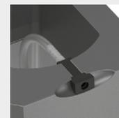
Adaptateur de tuyau positionné correctement
